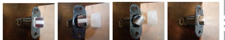
建具の吊元によりラッチの三角の部分の向きを変えられます。三角の部分に回りにある白いプラスチックを一旦取外します。三角の部分回転しますので、建具の吊元により方向を決めて回転させて下さい。白いプラスチックは方向を変えた後、また取付けて下さい。
